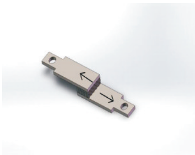
图3 阻尼器试样及受力方向
